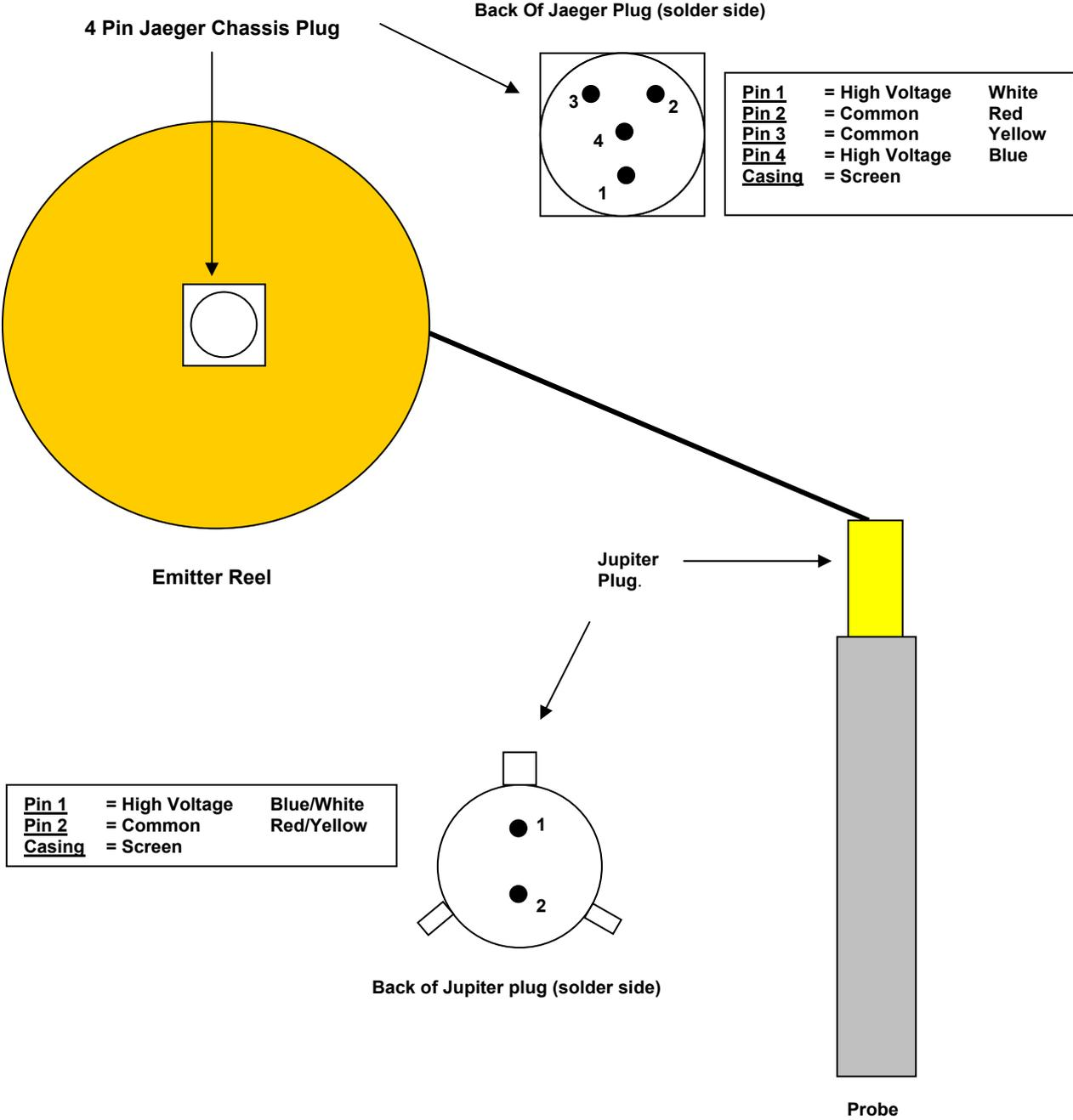
**Fig 6. Winch Reel Wiring.**
